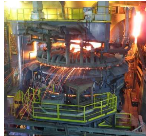
Scrap – EAF (25%) (Met schroot gevoede vlamboogoven) Secondaire staalproductie (uit schroot)
